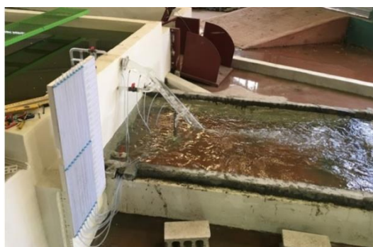
Hình 4. Mặt bằng và kết cấu xi phông trong thí nghiệm kiểm chuẩn
