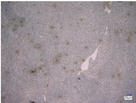
Hình 4. Tổ chức tế vi hợp kim M2 sau đúc ( \times 500 )
