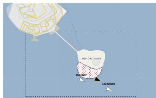
Hình 5. Xuất hiện tàu chưa định danh MMSI sau khi ra khỏi vùng cản trở sóng Radar
