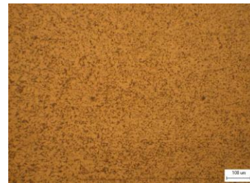
Hình 9. Tổ chức tế vi của thép trước khi gia nhiệt
