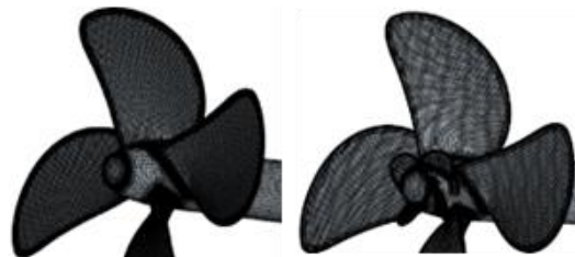
Hình 7. Kết quả chia lưới với trường hợp có chân vịt phụ và không có chân vịt phụ
