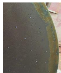
a) Bề mặt và mép cánh chân vịt sau sửa chữa
