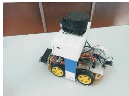
Hình 6. Robot gắn RPLidar được chế tạo
