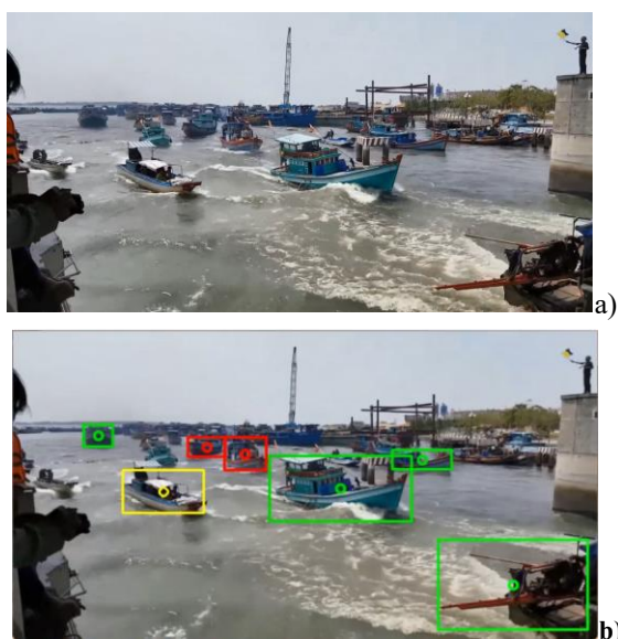
Hình 8. Ước lượng khoảng cách giữa an toàn giữa những tàu thuyền. a) là ảnh đầu vào, b) là ảnh kết quả ước lượng
