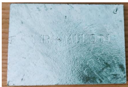
Hình 2. Mẫu sau khi mạ kẽm
