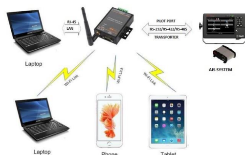
Hình 1. Sơ đồ kết nối giữa AIS-thiết bị chuyển đổi máy tính, thiết bị di động
