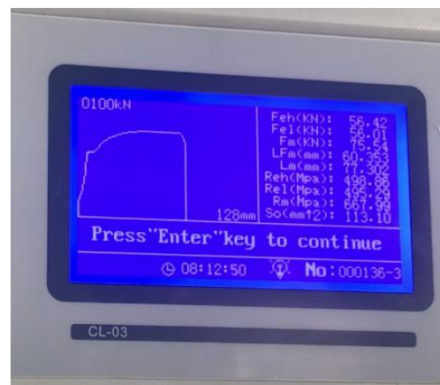
Hình 9. Màn hình kết quả thí nghiệm kéo thanh thép mẫu D12 với tốc độ gia tải 3,0kN/s
