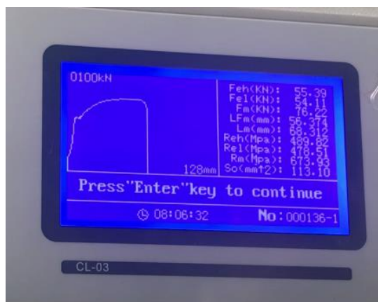
Hình 7. Màn hình kết quả thí nghiệm kéo thanh thép mẫu D12 với tốc độ gia tải 1,0kN/s
