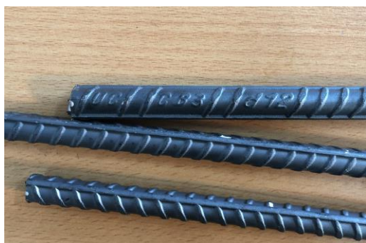
Hình 2. Ký hiệu của nhà sản xuất trên thanh thép (logo của nhà sản xuất, ký hiệu mác thép viết tắt CB3, đường kính d12)
