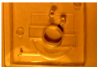
Hình 4. Hình ảnh của máy vi trộn tạo dòng xoáy 3-D
