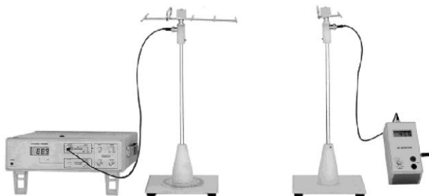
Hình 3a. Mô hình thí nghiệm đo đặc tính phương hướng của anten Yagi 5 chấn tử
