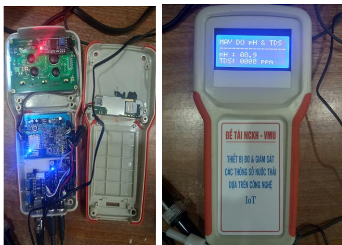
Hình 10. Mô hình thiết bị đo lường và giám sát thông số nước thải dựa trên công nghệ IoT
