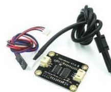
Hình 3. Cảm biến đo thông số TDS của hãng DFROBOT
