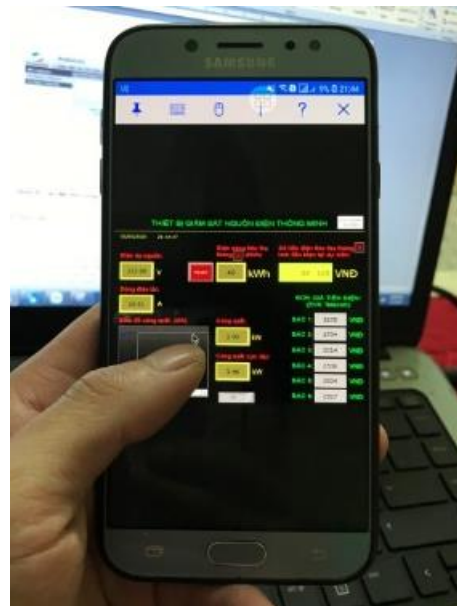
Hình 11. Giám sát và điều khiển từ xa bằng điện thoại qua sóng 3G
