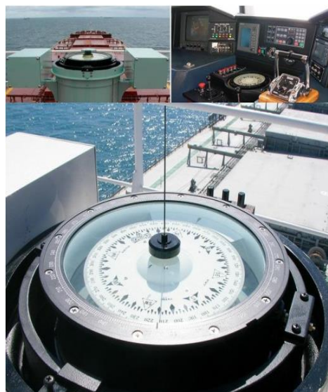
Hình 2. La bàn từ đặt tại mặt phẳng trực dọc tàu
