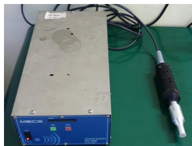
Hình 7. Máy khuấy siêu âm 20kHz với khuôn hàn
