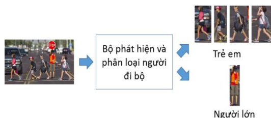
Hình 2. Hướng tiếp cận sử dụng bộ phát hiện và phân loại người đi bộ tích hợp
