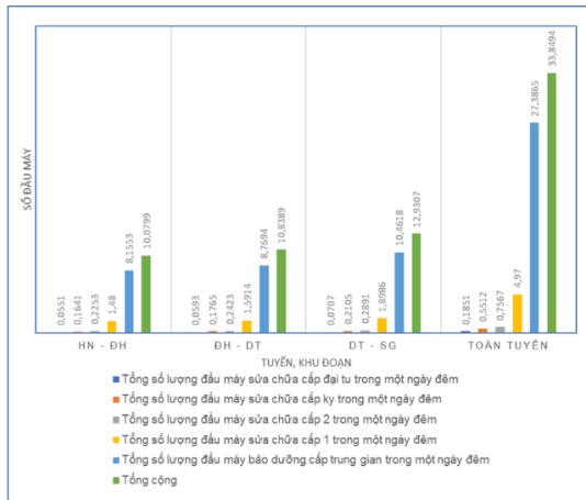
Hình 8. Biểu đồ phân bố số lượng đầu máy ở các cấp bảo dưỡng, sửa chữa trên các khu đoạn và toàn tuyến Hà Nội - Sài Gòn ứng với k=1,3
