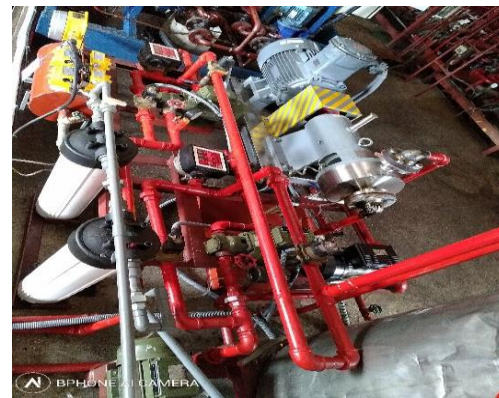
Hình 6. Hệ thống tạo nhiên liệu nhũ tương được lắp đặt thử nghiệm trên động cơ Hanshin 6LU32 [3]
