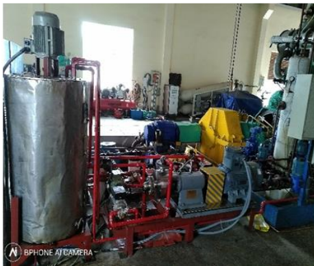
Hình 6. Hệ thống tạo nhiên liệu nhũ tương được lắp đặt thử nghiệm trên động cơ Hanshin 6LU32 [3]
