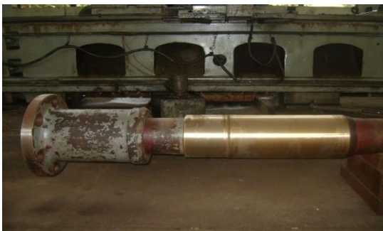
Hình 1. Trục chân vịt đã được bọc áo trục
