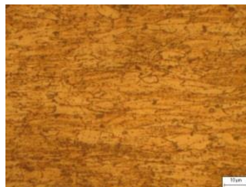
Hình 4. Tổ chức hợp kim Cu-9Ni-3Sn sau cán nóng và cán nguội 40%, hóa già ở 350°C, 1h; a-x500; b-x1000
