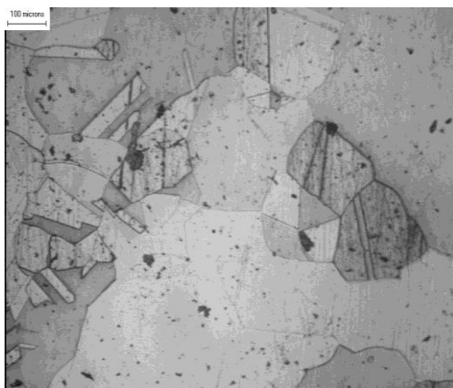
Hình 2. Tổ chức hợp kim Cu-9Ni-3Sn sau đồng đều ở 750°C, thời gian giữ nhiệt 2h, nguội trong nước
