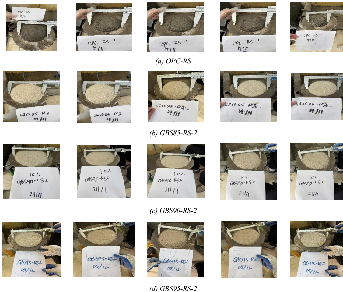
Hình 3. Hình ảnh thí nghiệm sự suy giảm độ lưu động của vữa tươi theo thời gian của các mẫu thí nghiệm: (a) OPC-RS (mẫu đối chứng), (b) GBS85-RS-2, (c) GBS90-RS-2, (d) GBS95-RS-2
