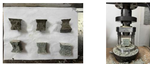
Hình 4. Thí nghiệm cường độ chịu nén của vữa geopolimer tại 7 ngày và 28 ngày
