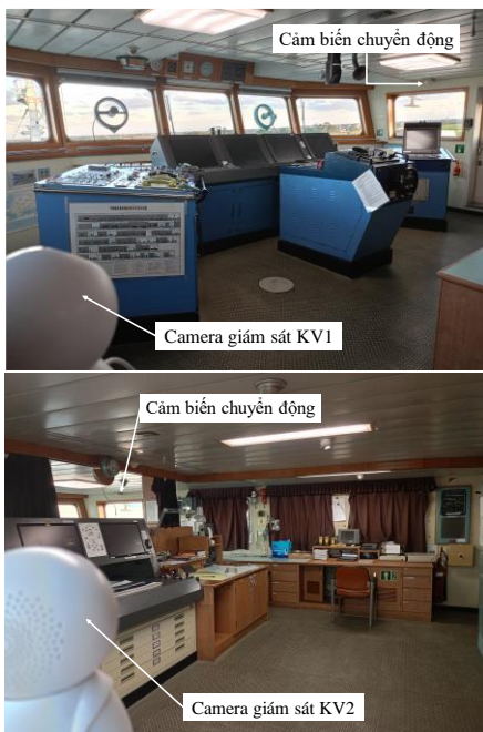
Hình 3. Đặt camera giám sát và cảm biến chuyển động tại buồng lái tàu VMU Việt-Hàn
