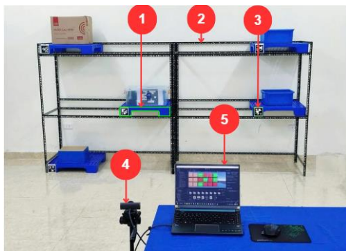
Hình 6. Mô hình vật lý hệ thống sau khi chế tạo 1. Pallet hàng hóa; 2. Kệ lưu giữ; 3. Mã AprilTag có ID; 4. Hệ thống camera; 5. Máy tính xử lý trung tâm.
