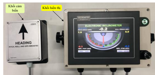
Hình 4. Thiết bị giám sát góc nghiêng sau khi chế tạo
