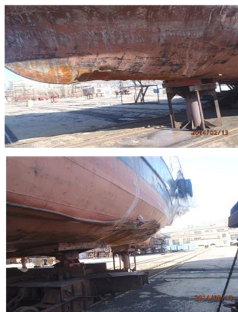
Hình 1. Hư hỏng ở đáy tàu hàng Kurilgeo do tương tác với nền đáy biển
