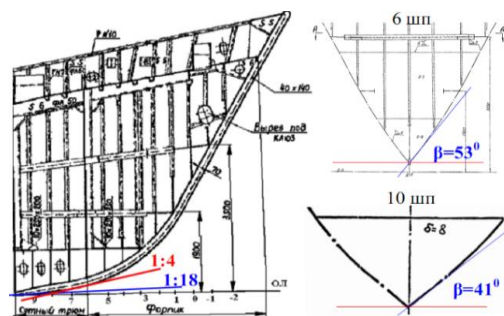
Hình 7. Hình dạng phần mũi tàu của tàu cá thuộc dự án 388, LB Nga
