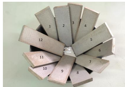
Hình 5. Mẫu thí nghiệm hợp kim nhôm độ bền cao B95
