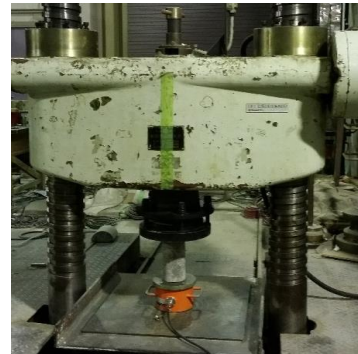
Hình 4. Sơ đồ thí nghiệm nén BTXM
