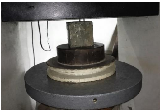
Hình 3. Sơ đồ thí nghiệm nén vữa
