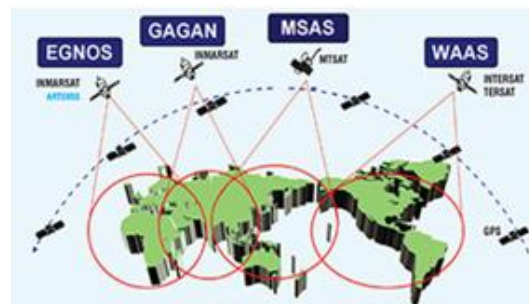
Hình 1. Hệ thống SBAS/EGNOS và SBAS/MSAS
