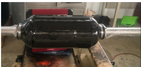
Hình 7. Quấn bình composit sợi cacbon T700/ nền epoxy
