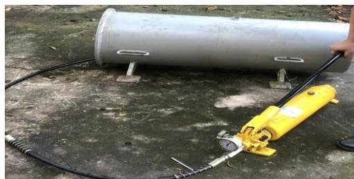
Hình 8. Thử nghiệm phá hủy bình composit
