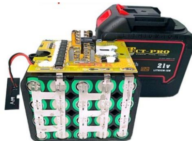
Hình 1. Mô-đun pin Li-ion 5S4P sử dụng cell 18650
