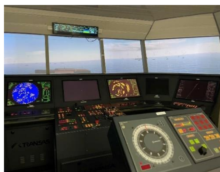
Hình 4. Phòng mô phỏng buồng lái chính của hệ thống mô phỏng
