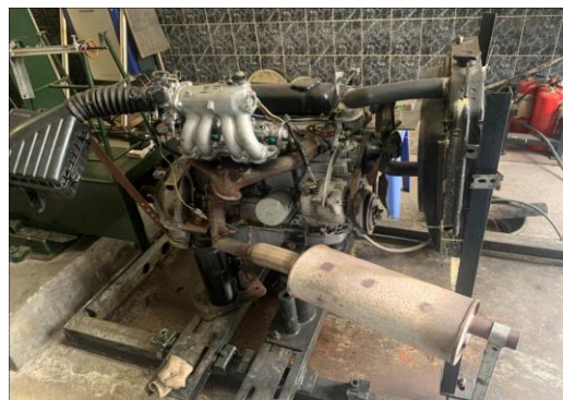
Hình 6. Động cơ sau khi hoàn cải hệ thống phun xăng điện tử
