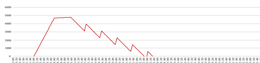
Hình 6. Năng lượng pin tiêu thụ trong chu kỳ vận hành liên tục 24 giờ, theo kịch bản thời gian cập cảng 10 phút
