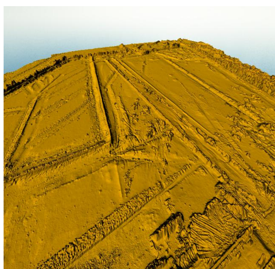
Hình 9. Kết quả khảo sát bãi cát san lấp bằng UAV
