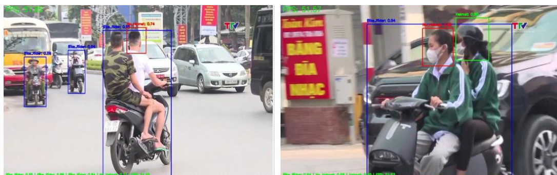
Hình 3. Kết quả phát hiện người đi xe máy không đội mũ bảo hiểm với dữ liệu test
