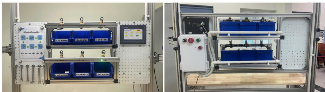
Hình 5. Sản phẩm hệ thống hộp đựng Poka-Yoke sau khi lắp đặt trên trạm lắp ráp thủ công
