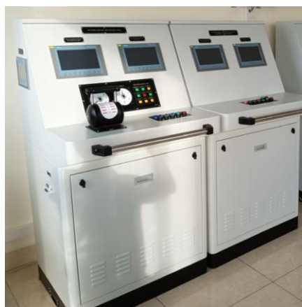
Hình 8. Mô hình mô phỏng máy chính
