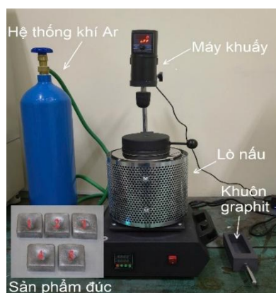
Hình 2. Bố trí hệ thống đúc khuấy và sản phẩm đúc
