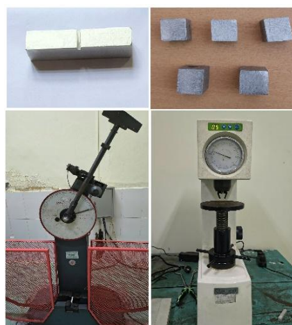
Hình 3. Mẫu đo cùng thiết bị đo độ cứng, độ dai va đập
