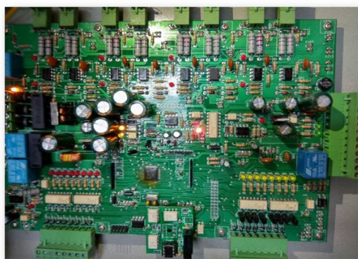
Hình 3. Vi báo cháy đã được chế tạo
