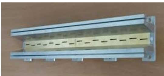
Hình 7. Anten khe ngoài thực tế với số khe là 16
