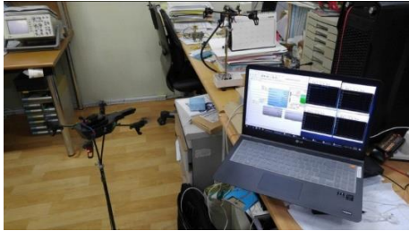
Hình 6. Thử nghiệm điều khiển thời gian thực qua Wifi với AR.Drone từ chương trình Matlab/Simulink trên máy tính
