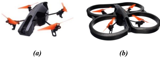
Hình 1. Hình ảnh thực tế AR.Drone 2.0: (a)- AR.Drone với bộ thân trong nhà; (b)- AR.Drone với bộ thân ngoài trời
