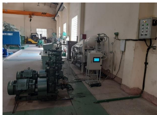
Hình 4. Hệ thống giám sát máy nén khí trong phòng thí nghiệm của trung tâm nghiên cứu hệ động lực
