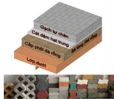
Hình 6. Kết cấu mặt đường thoát nước bằng các loại gạch/bê tông tự chèn (PICP)
