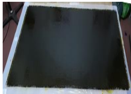
Hình 2. Prepreg nhựa nền phenolic/ cốt vải cacbon
