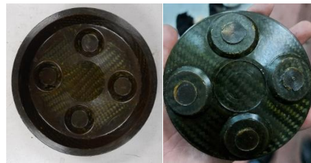
Hình 9. Sản phẩm đáy bảo vệ nhiệt đạt yêu cầu
