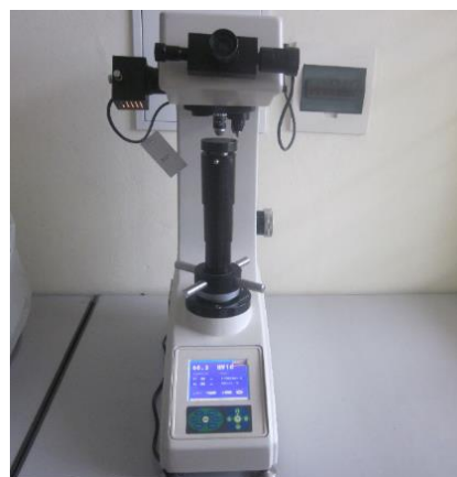
Hình 4. Máy đo độ cứng Vickers Wilson Wolpert (Trung Quốc)
