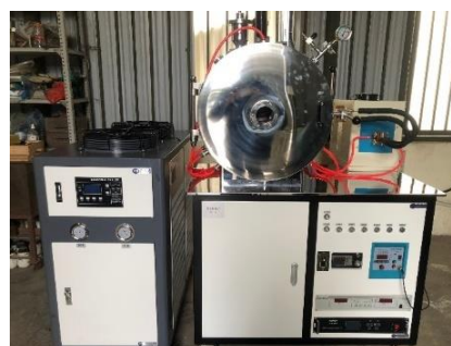
Hình 2. Kết cấu lò nấu chảy cảm ứng chân không VIF-2 (Trung Quốc)
