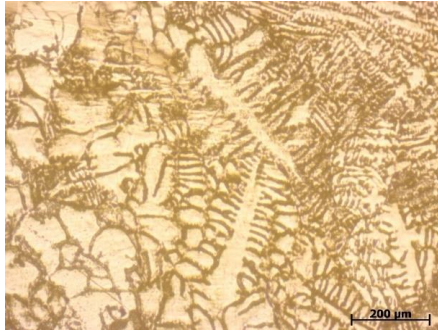
Hình 8. Tổ chức tế vi của hợp kim 79HM ở trạng thái đúc, x100
