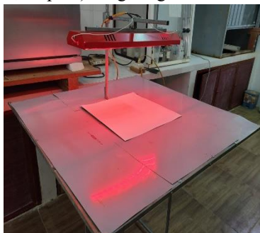
Hình 1. Thử nghiệm khả năng chống nóng của các loại sơn trong phòng thí nghiệm
