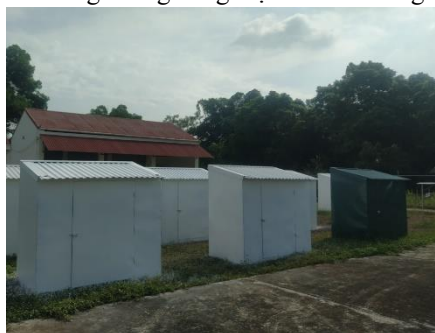
Hình 2. Thử nghiệm khả năng chống nóng ngoài trời của các loại sơn
