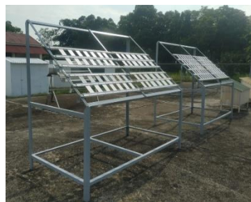
Hình 3. Thử nghiệm độ bền khí hậu của các loại sơn
