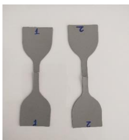
Hình 5. Mẫu vật liệu PVC thử nghiệm sau kéo đứt
