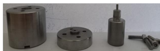
Hình 2. Đồ gá thí nghiệm đập mẫu nhỏ ở nhiệt độ thấp
