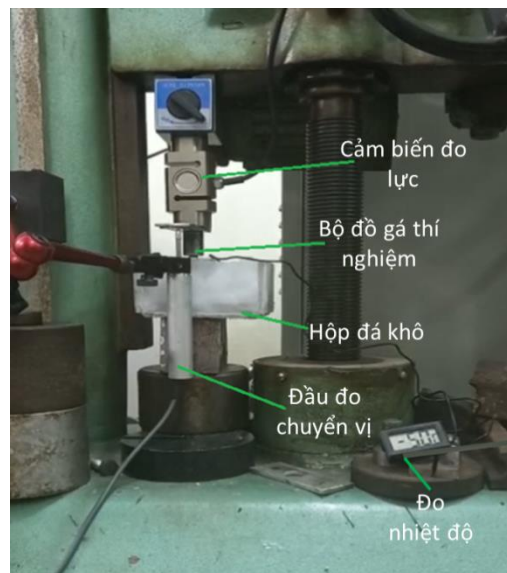
Hình 3. Sơ đồ gá đặt thí nghiệm đập mẫu nhỏ ở nhiệt độ thấp
