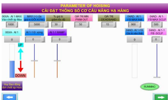
a. Màn hình cài đặt tham số cơ cấu nâng hạ hàng
